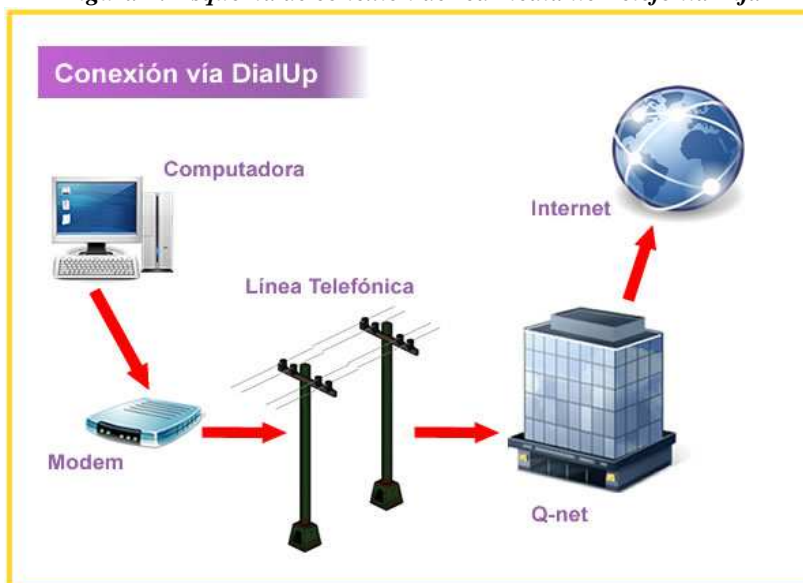
Figura 1: Esquema de conexión de red mediante Telefonía Fija
